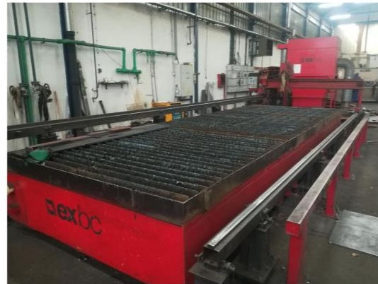
Varstroj TRC 121- CNC plasma cutting machine
